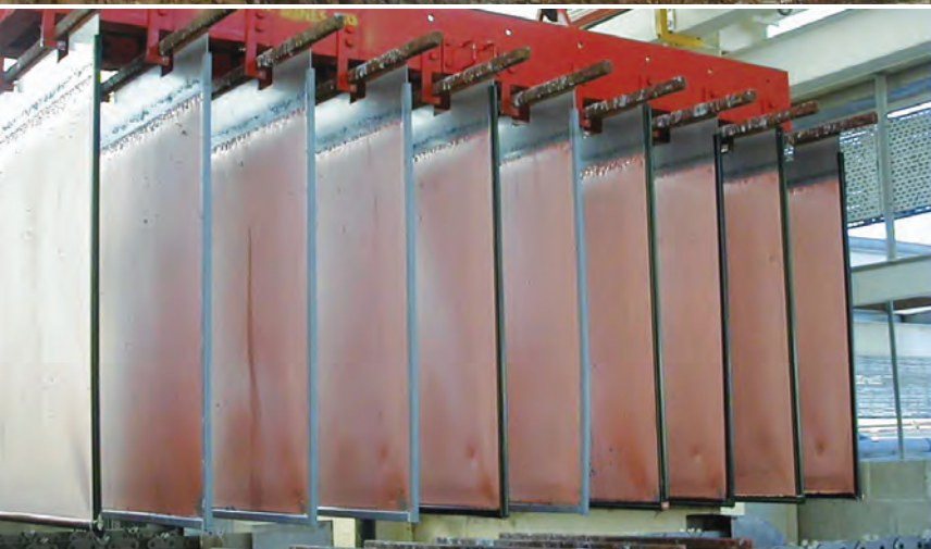
Εικ. 52: Σωρός εκχύλισης χαλκούχου μεταλλεύματος (πάνω) και δέσμες μεταλλικού χαλκού περιεκτικότητας 99,999% Cu (κάτω)
